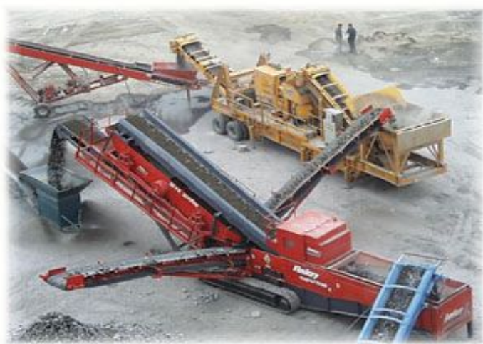
Slika 55. Mobilno postrojenje za “suvu” separaciju krečnjaka
