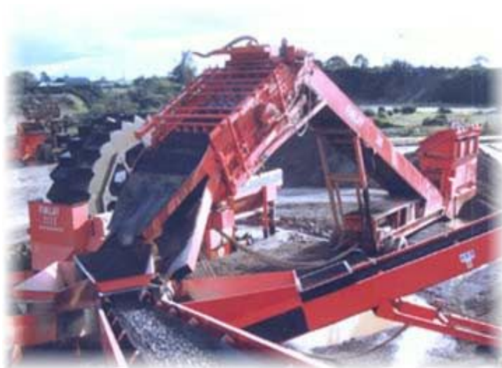
Slika 56. Pokretno postrojenje za „mokru“ separaciju
