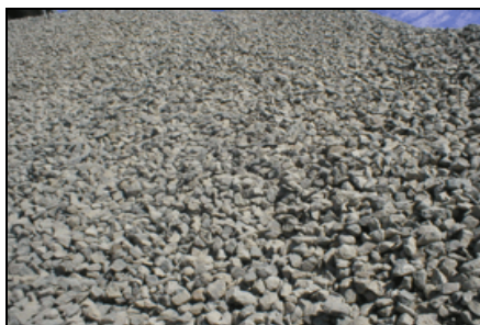
Slika 18. Prikaz drobljenog i separisanog kamena
