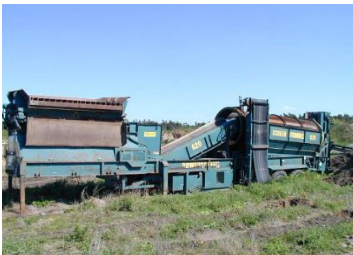
Slika 54. Mobilno postrojenje za “suvu” separaciju krečnjaka
